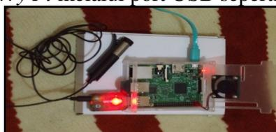
Gambar 8. Rangkaian *Raspberry Pi* dan Mikrofon
